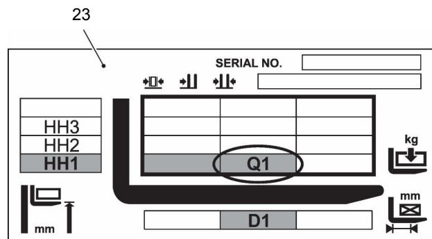
Le diagramme de charge (23) indique la capacité maximale Q (en kg) pour un centre de charge C donné (en mm) et une hauteur de levée correspondante H (en mm) pour le chariot avec une charge horizontale.
