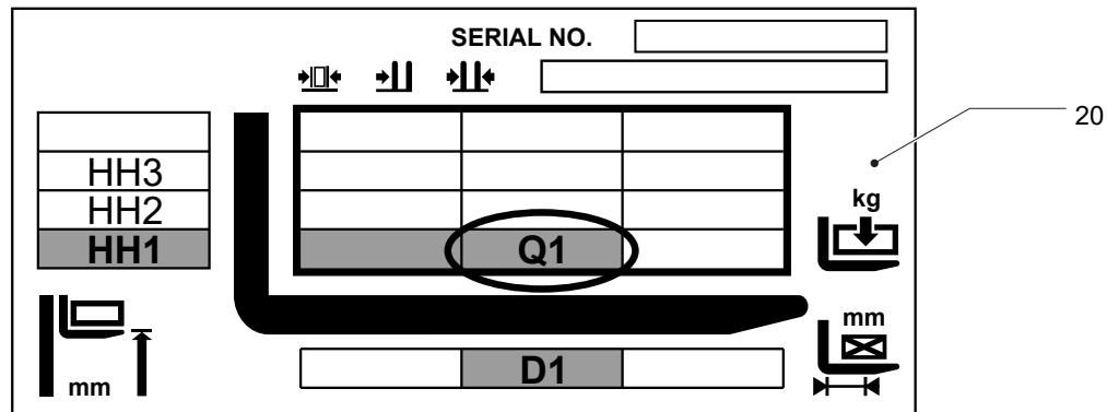
Le diagramme de charge (20) indique la capacité maximale Q (en kg) pour un centre de charge C donné (en mm) et une hauteur de levée correspondante H (en mm) pour le chariot avec une charge horizontale.
