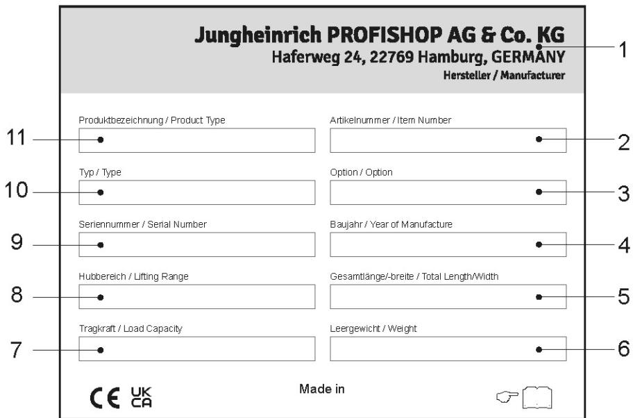
Abb. 1: Typenschild (schematisch)
