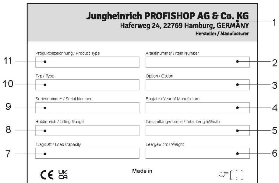
Ilust. 1: Placa de identificação (representação esquemática)
