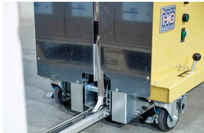
Zuverlässiger Bandtransport unter der Palette durch Klappensystem
