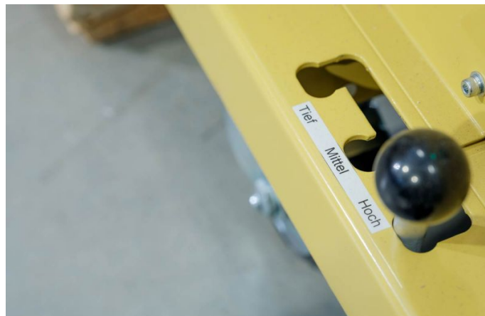
Höhenverstellbare Lanze für alle gängigen Palettentypen
