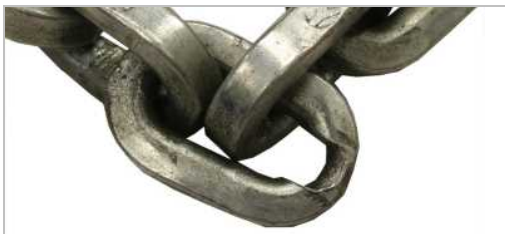
Das Kettenglied ist stark abgenutzt.
