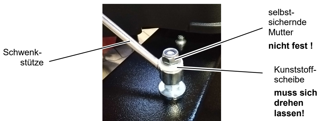
Abbildung 10: Befestigung der Schwenkstütze
