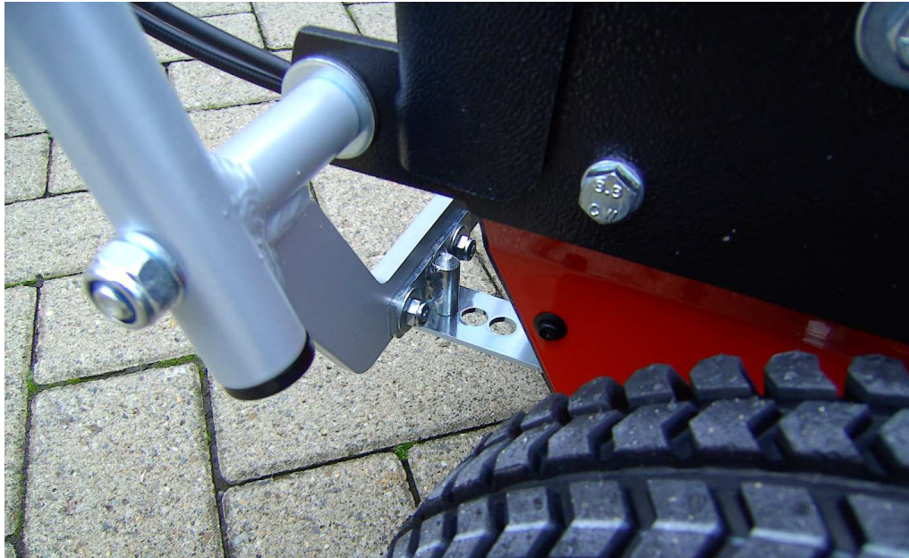
Abbildung 7: korrekte Montage des Rastfingers
