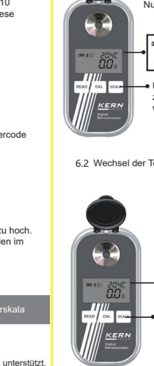
Während "CAL" blinkt drücken Sie nochmals "CAL", um die Kalibrierung auszuführen. Bei erfolgreicher Kalibrierung zeigt das Display "End" an (siehe unten). Nach spätestens 10 Sekunden erfolgloser Kalibrierung wird diese abgebrochen.
