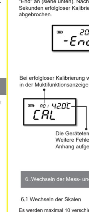
Bei erfolgloser Kalibrierung wird ein Fehlercode in der Multifunktionsanzeige angegeben.
