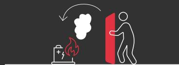
**3** Stellen Sie sicher, dass die Löschdecke rundherum und am Boden des brennenden Objekts fest anliegt. Warten Sie mindestens 20 Minuten, bevor Sie die Löschdecke entfernen.
