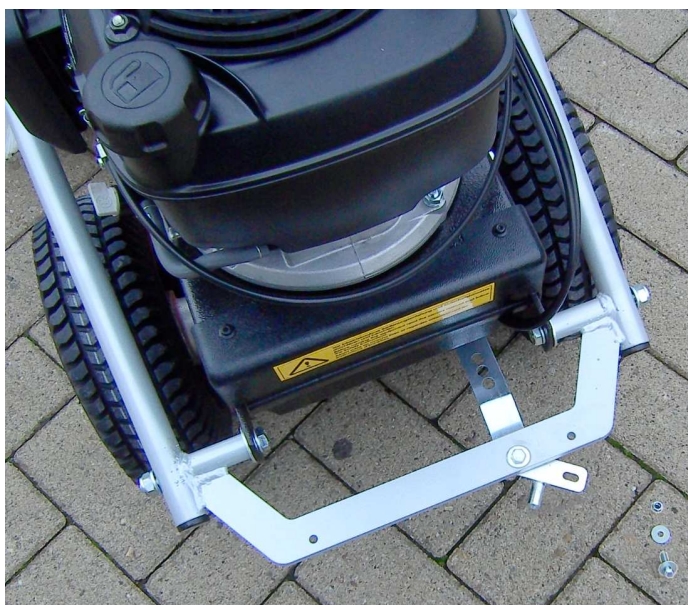
Abbildung 5: Ausrichten des Rastfingers
