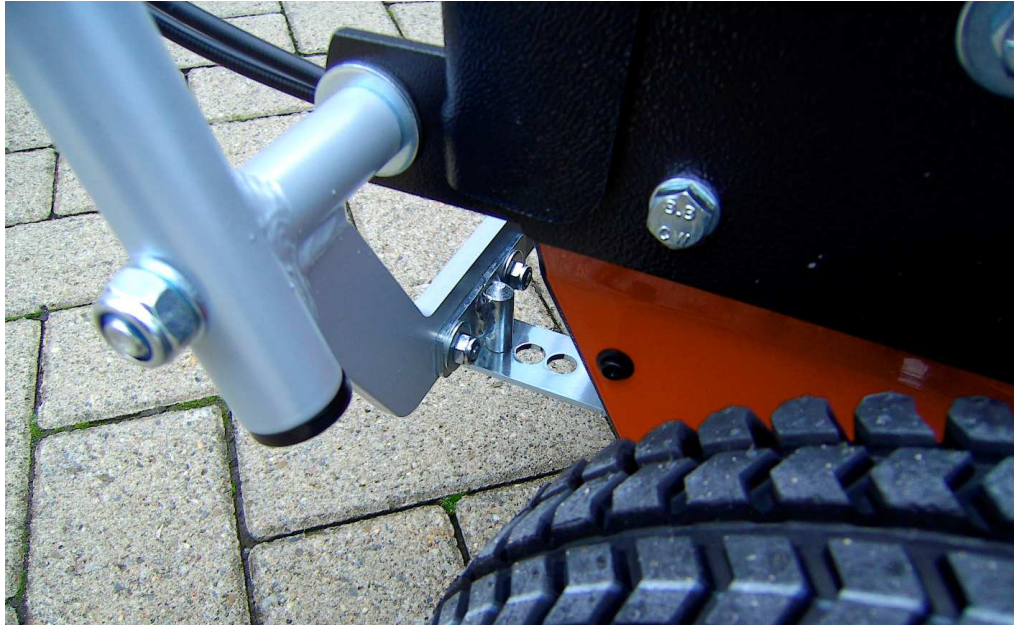
Abbildung 6: korrekte Montage des Rastfingers
