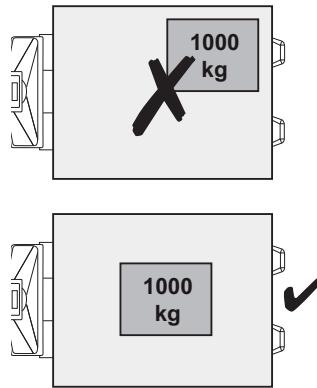
Ein exaktes Wiegeergebnis erhält man, wenn der Lastschwerpunkt zwischen den Gabeln liegt. Optimal für genaue Wiegungen ist glatter, ebener Boden.
