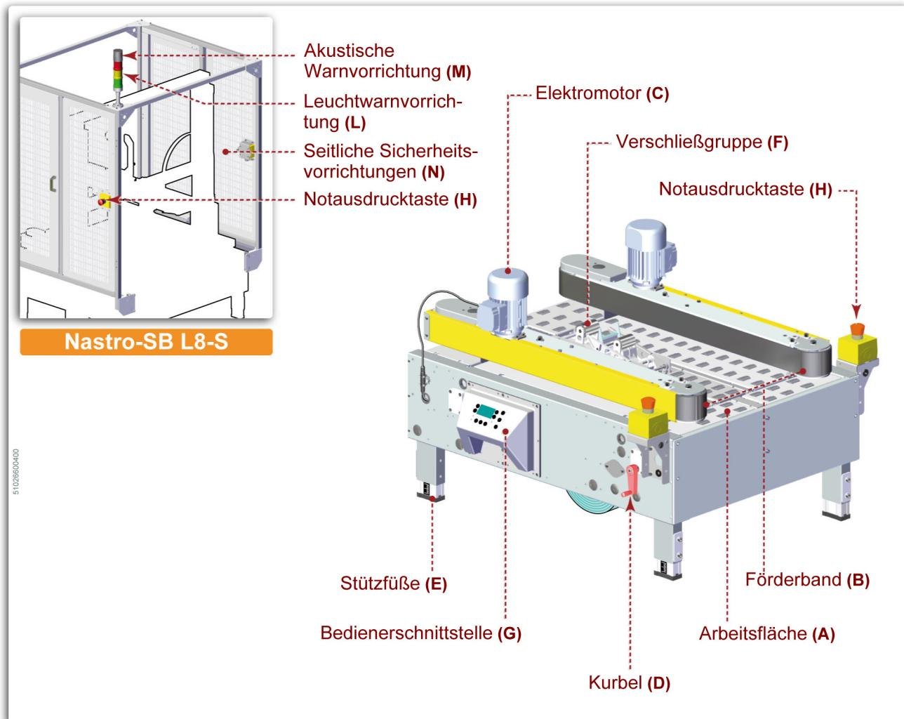
**A) Arbeitsfläche:** Sie ist mit Rollenförderern mit Losrollen ausgestattet, um den Beförderungsprozess der Schachtel zu erleichtern.
