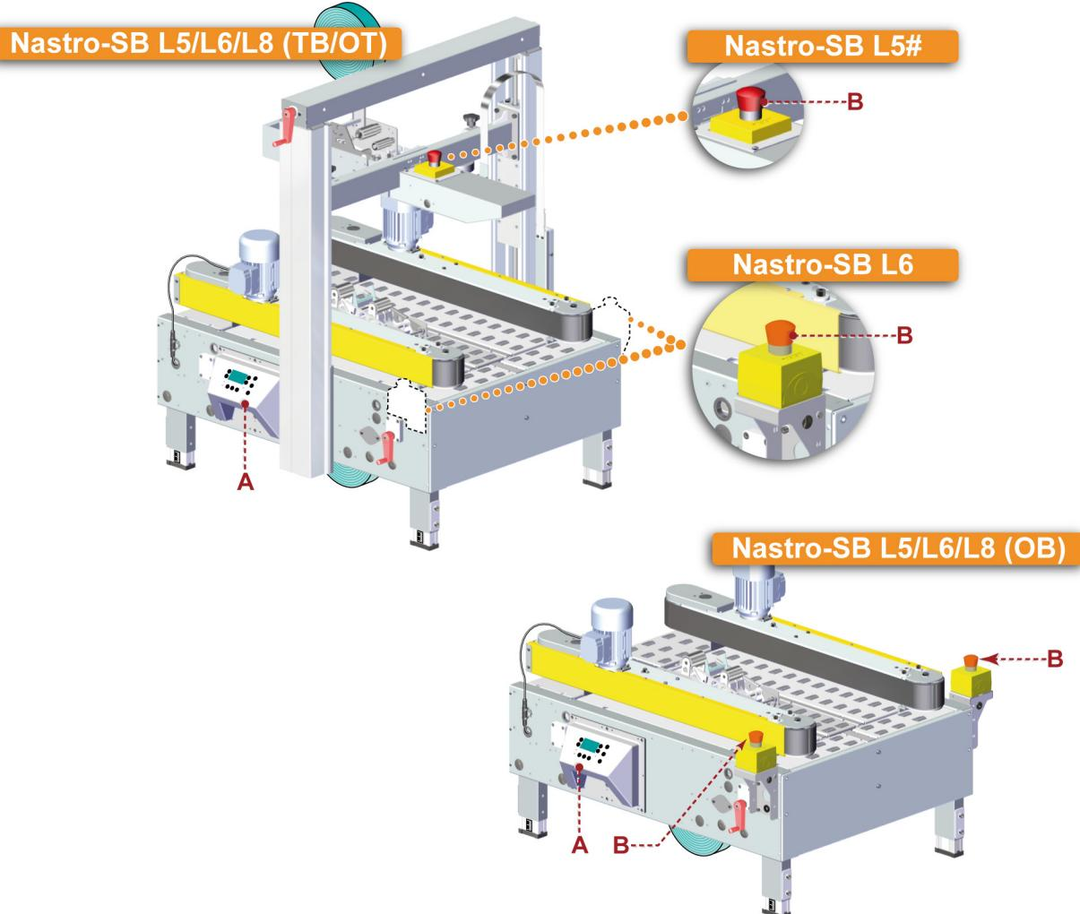
**A) Bedienerschnittstelle:** Steuerungssystem für die Programmierung und Anzeige des Betriebszustands der Maschine.
