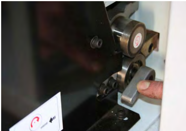
Hebel zum einlegen des Bandes drücken
