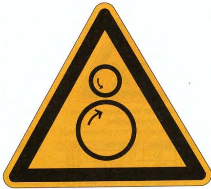
Warnung vor Einzugsgefahr ASR A 1.3/W030, BGV A8/W30, DIN 4844/W030
