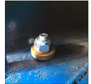
TELLERFEDERN NICHT SO MONTIEREN
