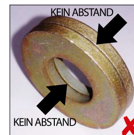
TELLERFEDERN NICHT SO MONTIEREN
