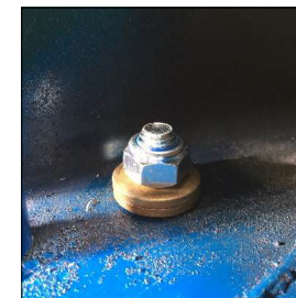
TELLERFEDERN NICHT SO MONTIEREN
