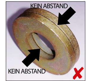
TELLERFEDERN NICHT SO MONTIEREN
