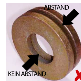
TELLERFEDERN NICHT SO MONTIEREN
