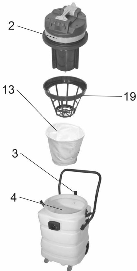
→ Cambiar el filtro antipolvo del motor (13) en caso necesario.
